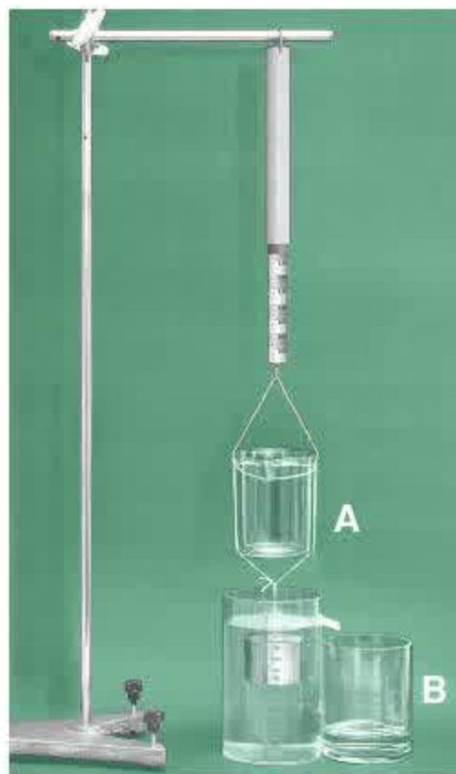
b) Nhúng vật nặng vào bình tràn đựng đầy nước, nước từ bình tràn chảy vào cốc B. Lực kế chỉ giá trị P_2 .
